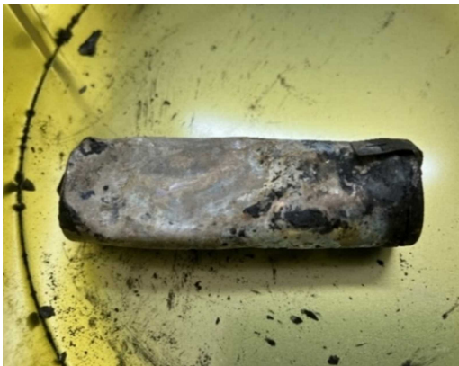
ペットボトルのリサイクル処理中、発火した乾電池
