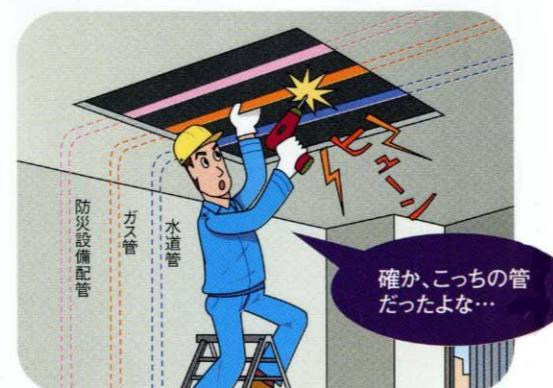
ガス事業者に事前照会を行わず、ガス管と防災設備配管を誤認。また、ガス臭かったにもかかわらず、ガス事業者に通報せず、工事を続けてしまいました。
