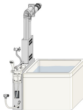
＜ガスふろがま（自然給排気式）＞
