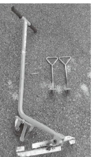
▲側溝の蓋上げ器具 (左:1人用/右:2人用)
