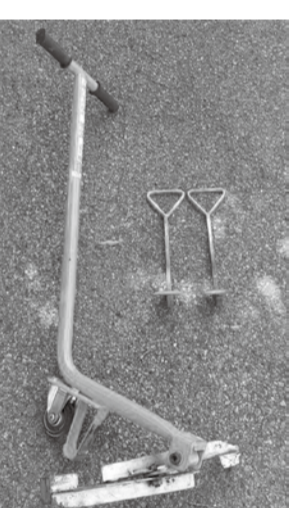
▲側溝の蓋上げ器具(左:1人用/右:2人用)
