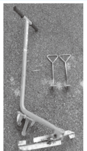
▲側溝の蓋上げ器具(左:1人用/右:2人用)
