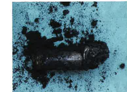
火災の原因と判定されたリチウムイオン電池の残骸
