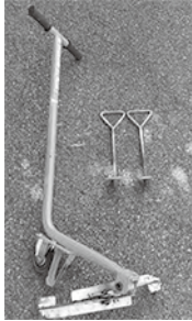
▲側溝の蓋上げ器具 左：1人用 右：2人用
